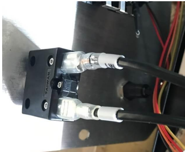
Figure 13 : Retrait du protecteur de surcharge 110 V
