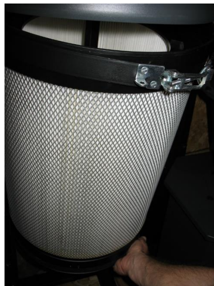
Figures 16D & 16E : Démontage du filtre extérieur pour le nettoyage
