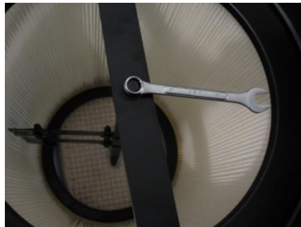
Figure 16B : Démontage du boulon d'articulation du volet (en dessous)
