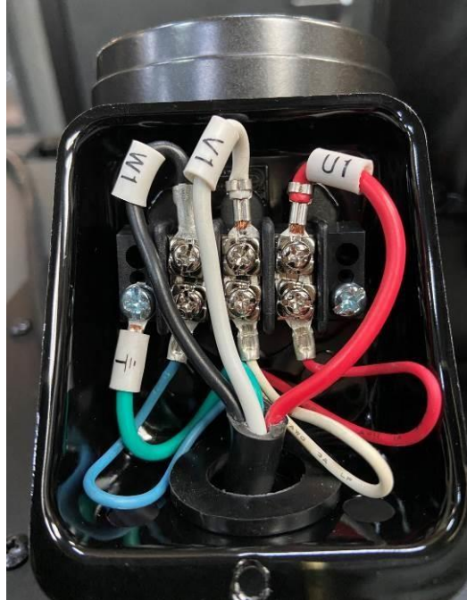
Figure 19 : câblage inférieur 220 V dans la boîte de jonction Figure 20 : câblage supérieur 220 V dans la boîte de jonction
