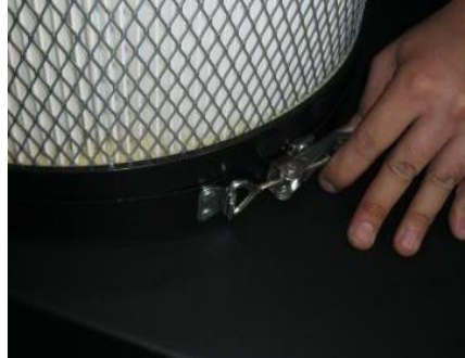
Figure 16A : Desserer le collier de serrage du sac
