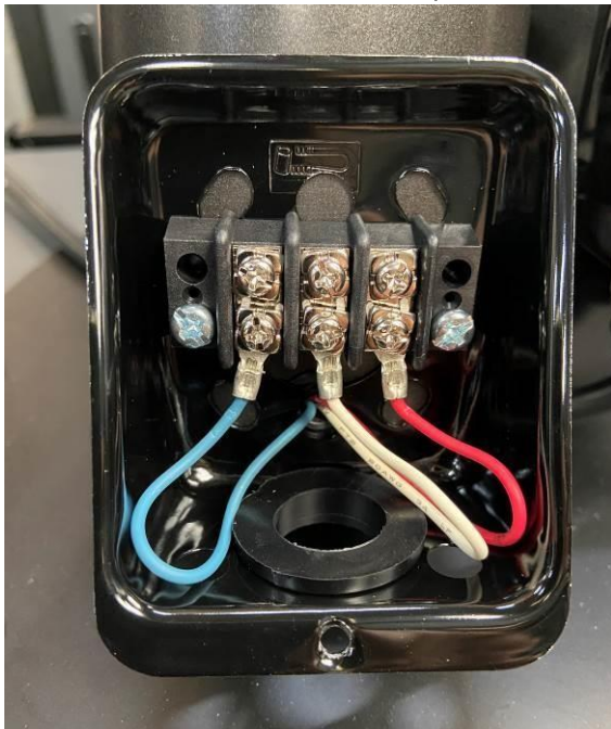
Figure 19 : câblage inférieur 220 V dans la boîte de jonction Figure 20 : câblage supérieur 220 V dans la boîte de jonction
