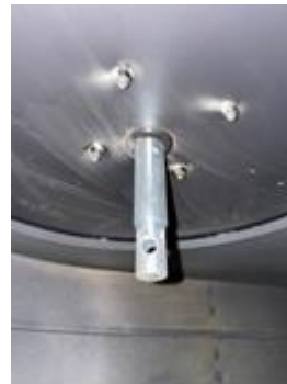
Figures 16F & 16G : Démontage de l'arbre de rotation
