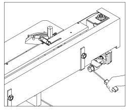
Fig: 6 ADJUST ROLLER TO TARCK BELT SEE FIG. 6
