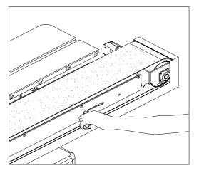
Fig: 6A ADJUST ROLLER TO TRACK BELT SEE FIG.6
