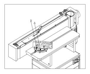
Fig: 5 1.MITER GAUGE (A) CAN BE ADJUSTED 45° - 90° AND CLAMPED BY HEX. HANDLE (B), SEE FIG.5 2.ADJUST MITER GAUGE(A)2.ADJUST MITER GAUGE(A) TO GET REQUIRED ANGLE GAUGE.
